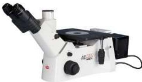
AE2000MET BF/DF представляет собой инвертированный промышленный микроскоп, позволяющий работать с твердыми образцами сложной формы и крупных размеров. К ним относятся металлические детали, материалы, минералы, формы, отливки и т.п., которые сложно наблюдать или тестировать на наличие дефектов с использованием микроскопа с вертикальным обзором в целях исследования материалов и контроля качества.
